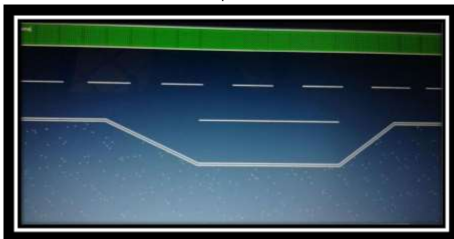
Figura 4- imagem representativa da proposta de uma entrada para embarque e desembarque de alunos.
