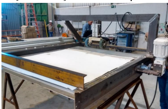
Figura 4. Gabarito utilizado para testar a instalação e fabricação de novos componentes.
