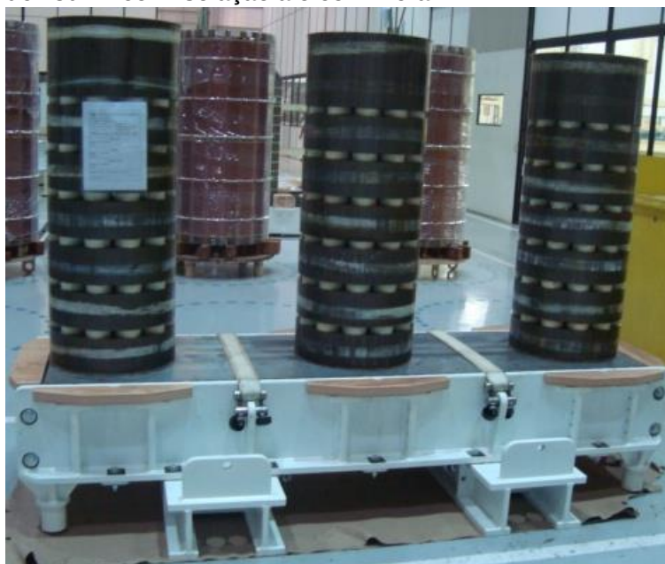
Figura 8. Núcleos de um reator para uso em tensão nominal de 230 kV com isolamento a óleo mineral.
