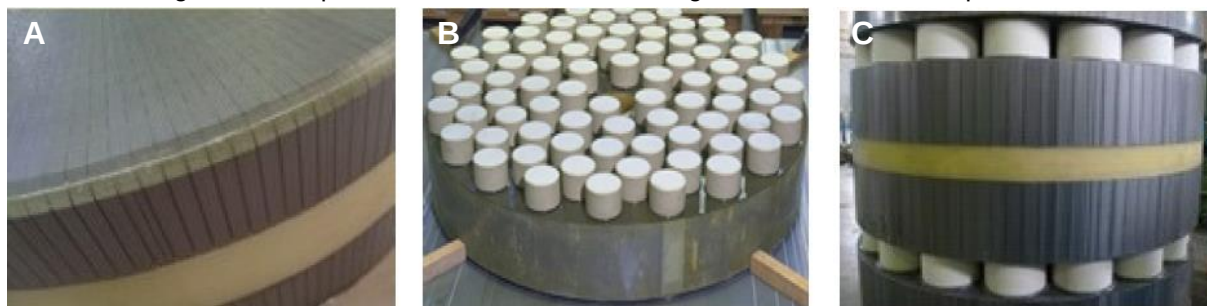
Figura 7. Núcleo de um reator durante o processo de fabricação. A. Segmento de material ferromagnético. B. Camada de espaçadores posicionadas e C. Montagem completa de um segmento do núcleo, em seguida são repetidas as camadas até se atingir o dimensionamento previsto.
