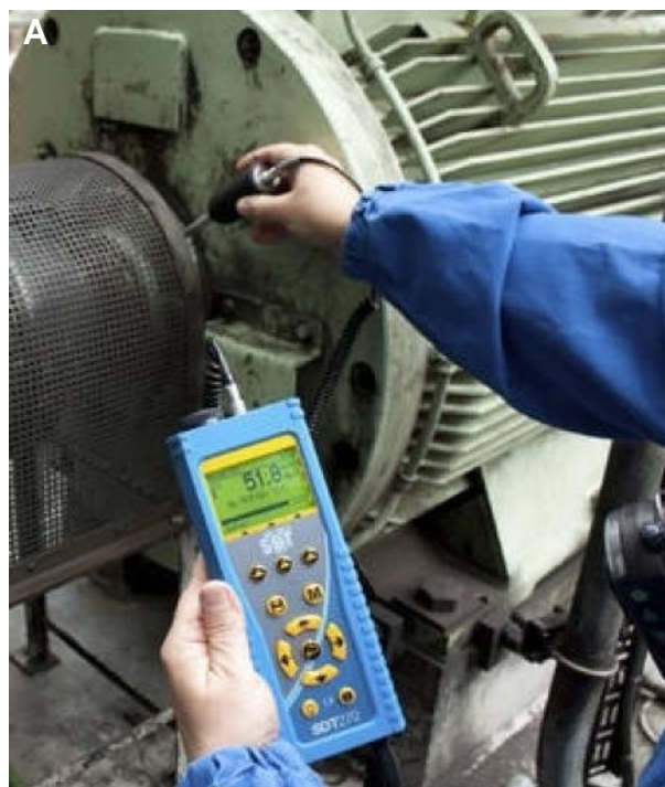
Figura 5. Equipamentos utilizados para a realização da manutenção preditiva.
