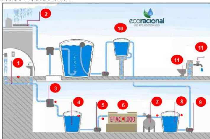
Figura 6. Representação esquemática do sistema de reuso Ecoracional.
