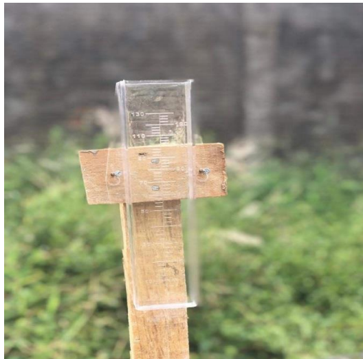
Figura 7. Colocação do dispositivo pluviômetro para a captação da água da chuva.
