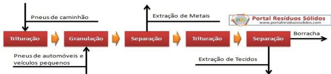
Figura 2. O processo de reciclagem do pneu.
