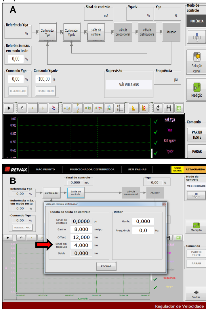
Figura 4. Interface Homem Máquina regulador de velocidade. A. Bloco “Saída de Controle”. B. Comando da válvula proporcional.
