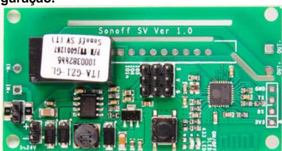
Figura 3. Placa Sonoff SV com suas entradas, saídas, conexões e botão de controle e configuração.
