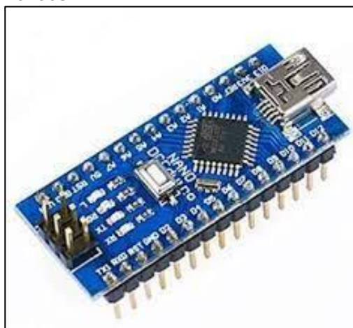
Figura 1. Imagem do Arduino nano V3 com suas entradas, saídas, pinos e conexões.
