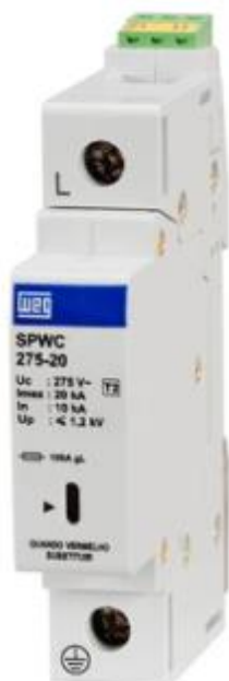
Figura 3. Dispositivo de proteção contra surtos (DPS). Atua na proteção da rede contra tensões elevadas que prejudicam os aparelhos nas residências, além de proteger contra descargas atmosféricas.
