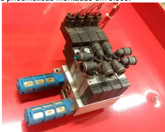
Figura 7. Conjunto de Válvulas pneumáticas montadas em bloco. Representação de Válvulas pneumáticas montadas em bloco.
