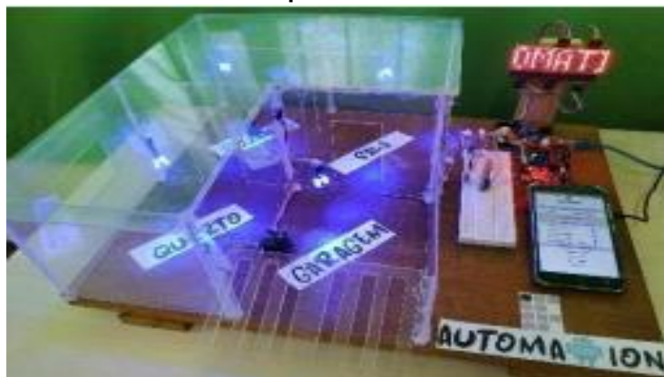
Figura 5. Maquete utilizada como demonstração do funcionamento de uma simples domótica.
