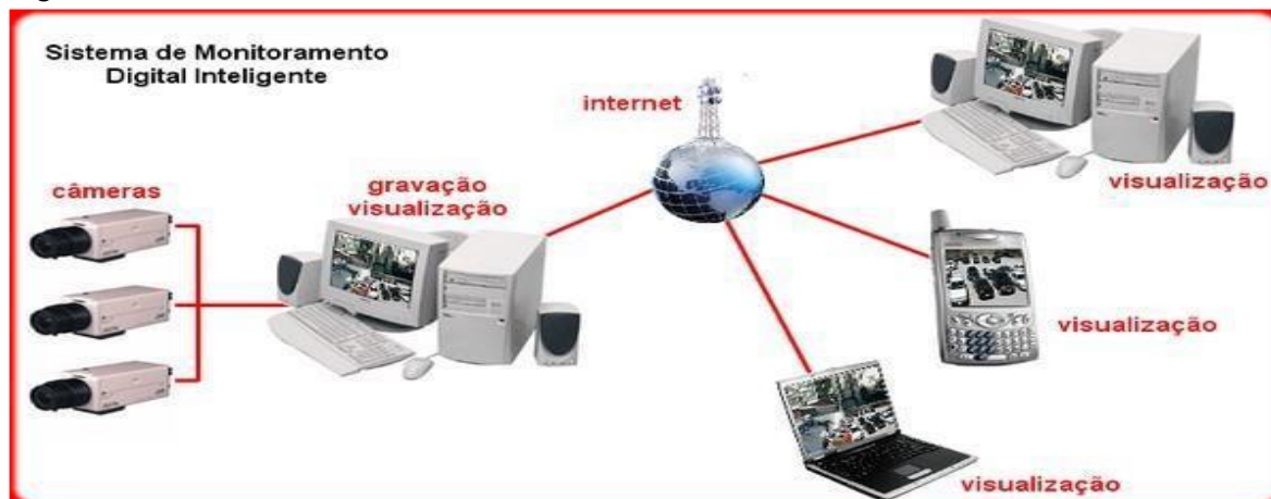
Figura 2. Estrutura básica de um sistema de monitoramento.
