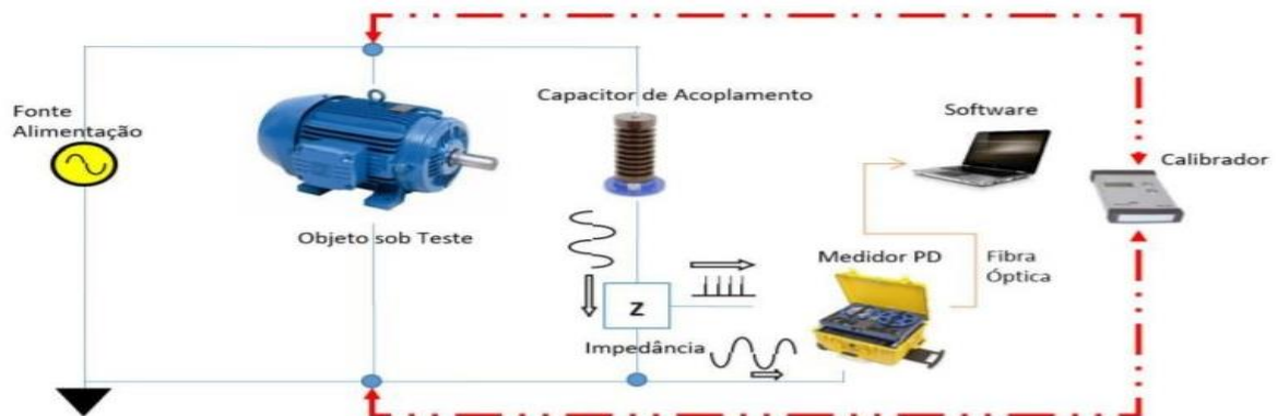
Figura 1. Esquema de ligação do ensaio de descargas parciais com calibrador em paralelo ao circuito.
