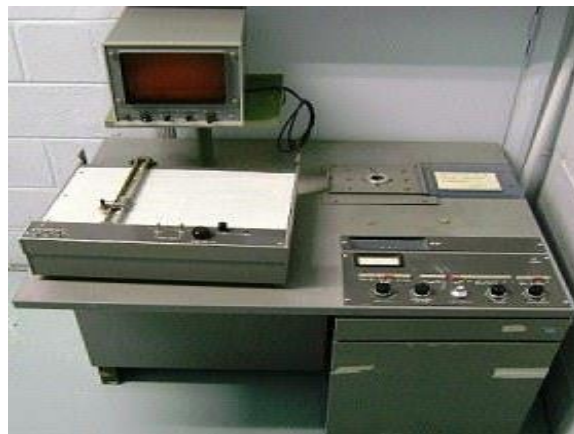
Figura 1. Aparelho de RMN de 1,4 Tesla, marca Hitachi Perkin-Elmer, modelo R22-A.
