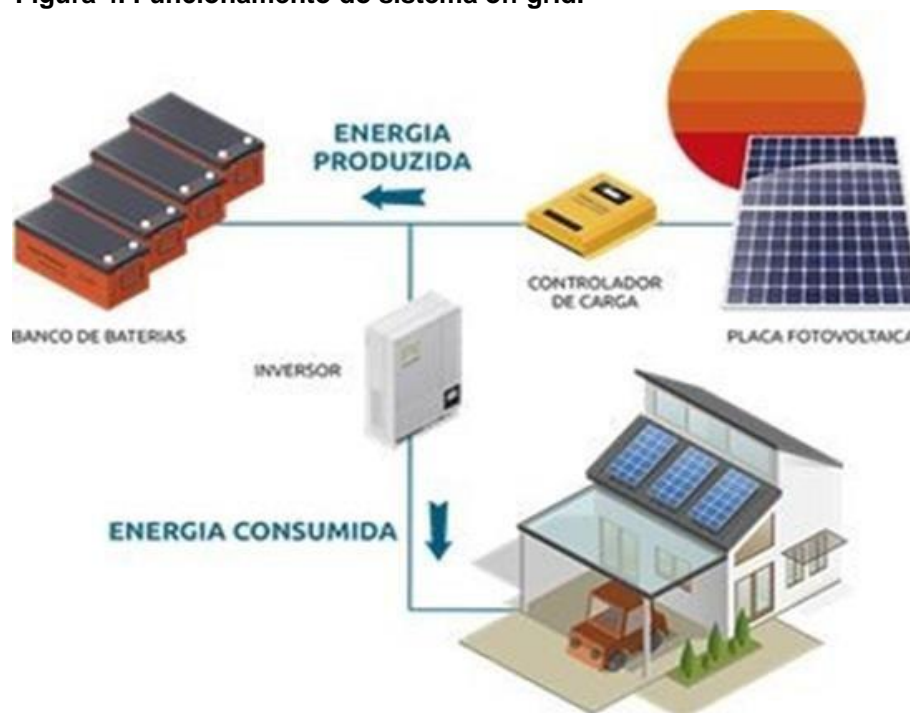
Figura 4. Funcionamento do sistema off grid .
