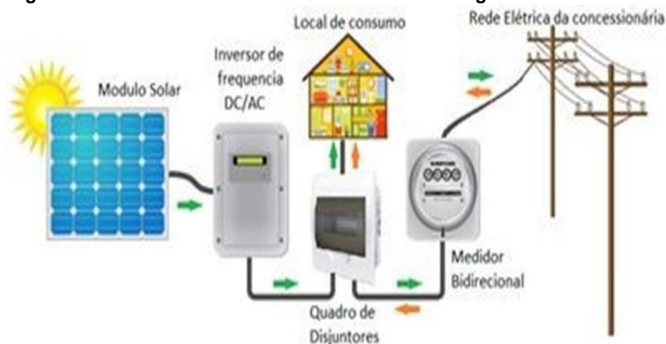
Figura 5. Funcionamento do sistema fotovoltaico on grid.
