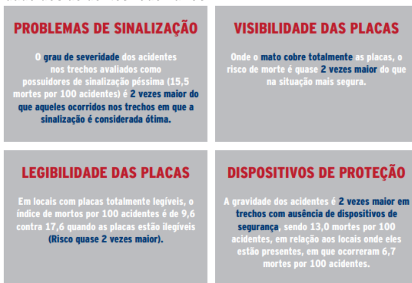
Figura 4. Problemas de sinalização aumentam o grau de severidade dos acidentes rodoviários.
