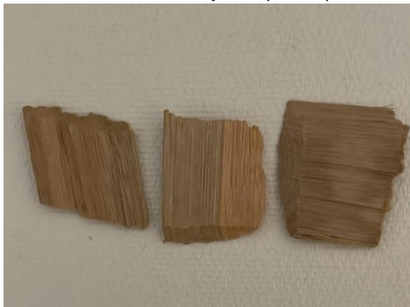
Figura 5. Cavacos aceites. Cavacos com 13mm e espessuras menos que 8mm. Considerados aceites, dimensões desejáveis para o processo.
