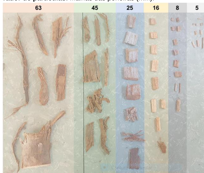
Figura 4. Tipos de cavacos retidos em cada peneira do separador de partículas. Malhas das peneiras (mm).
