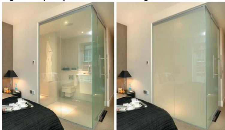
Figura 6. Aplicação de um vidro inteligente.
