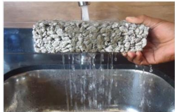
Figura 2. Demonstração de um paver de concreto permeável. Pode-se visualizar a permeabilidade do paver ao entrar em contato com a água.
