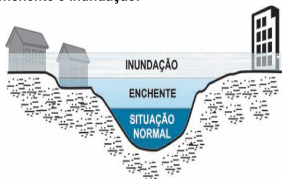
Figura 1. Perfil esquemático dos processos de enchente e inundação.
