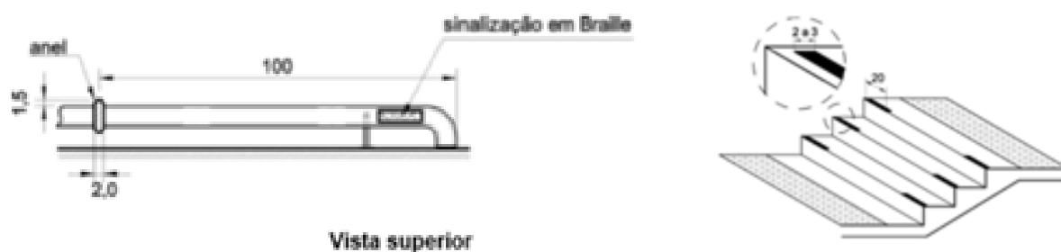
Figura 1. Sinalização de escada pública, conforme NBR 9050 (2015). A. Sinalização tátil no corrimão. B. Sinalização tátil dos pisos.
