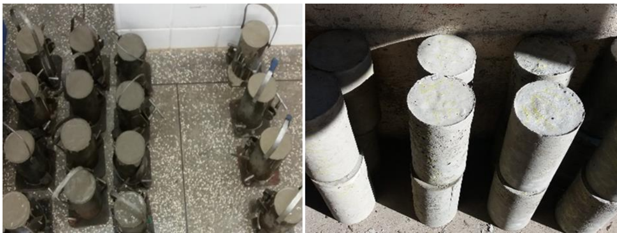
Figura 2. Imagens dos moldes (A) e dos corpos de prova (B).
