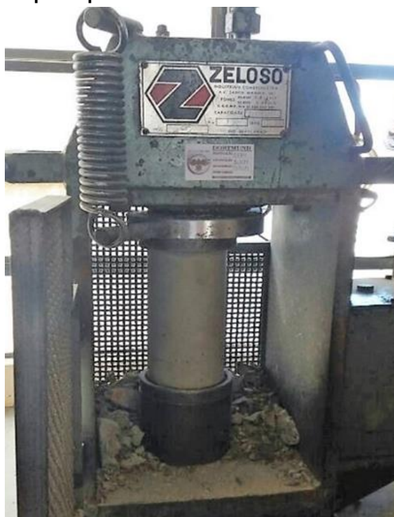
Figura 3. Prensa realizando o rompimento do corpo de prova.
