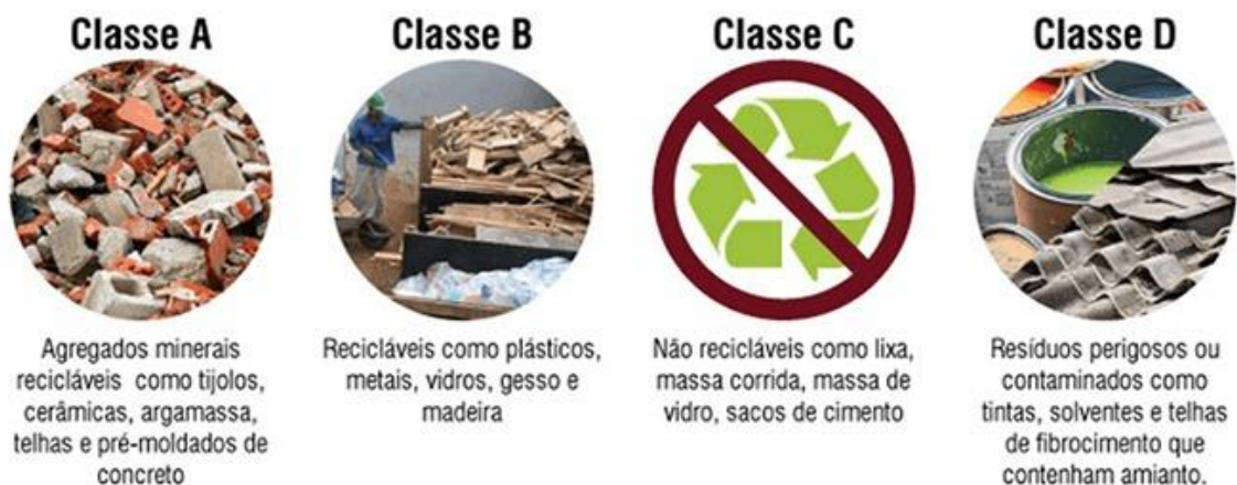
Figura 2. Classificação de resíduos da construção civil.
