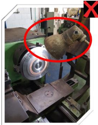
Figura 2. Falta de iluminação no torno NDT 650/1981.
