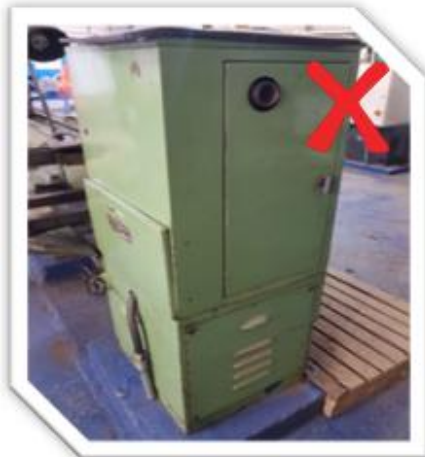
Figura 3. Falta de bloqueio e proteções móveis e fixas no torno NDT 650/1981. É possível constatar que a máquina não possui botão e nem qualquer outro dispositivo impeça a reenergização ou sinalização de advertência.
