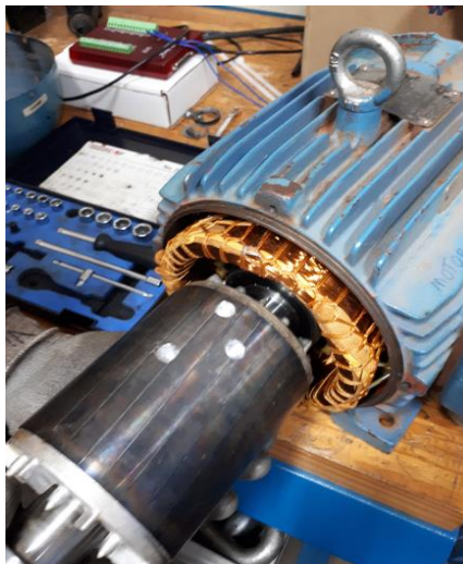
Figura 2. Barras quebradas do rotor.
