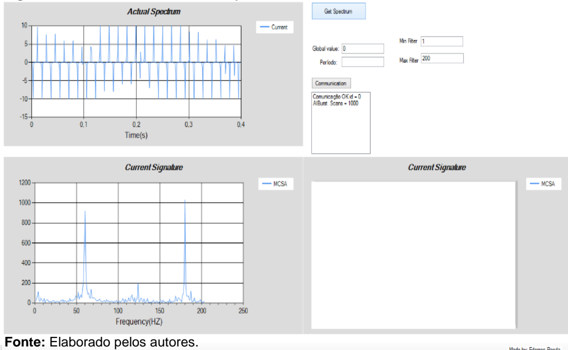
Figura 5. Partida direta com barras quebradas.
