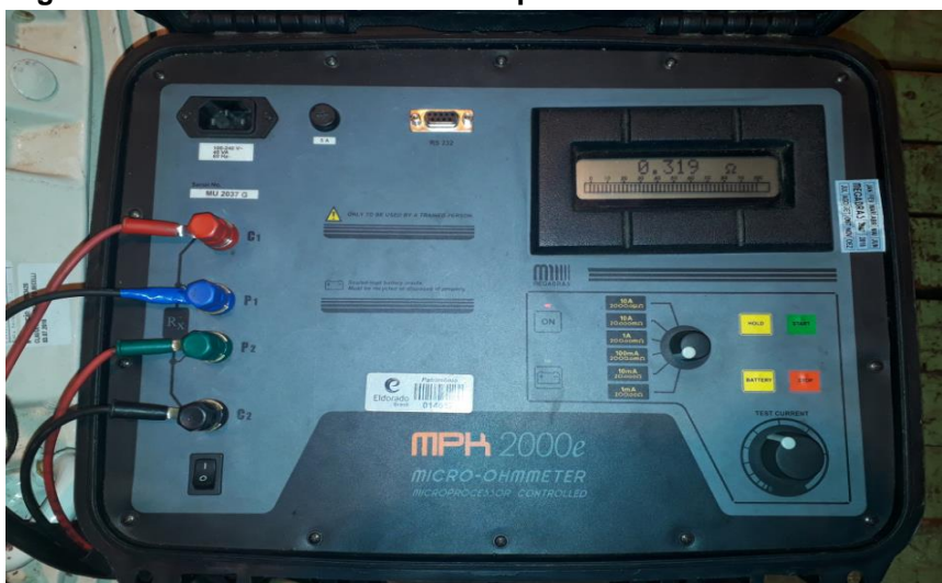
Figura 10. Resistência entre fases equilibrada.
