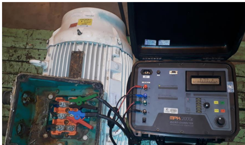
Figura 9. Teste de resistência entre fases.
