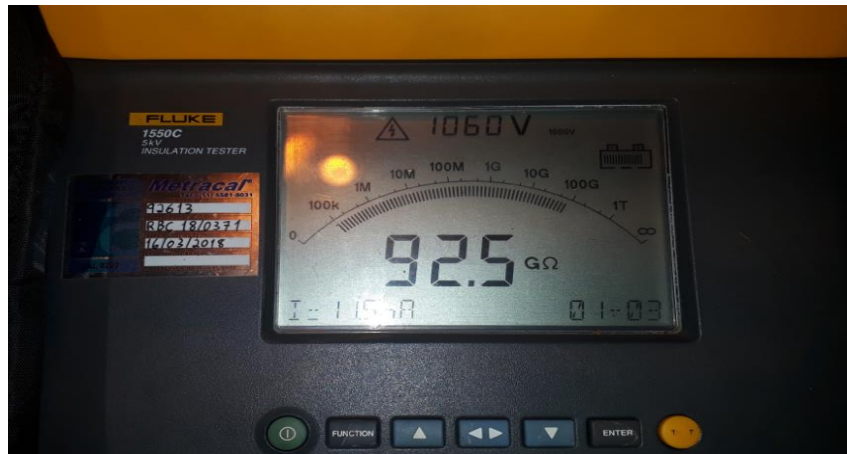
Figura 12. Resistência de isolamento por 1 minuto.
