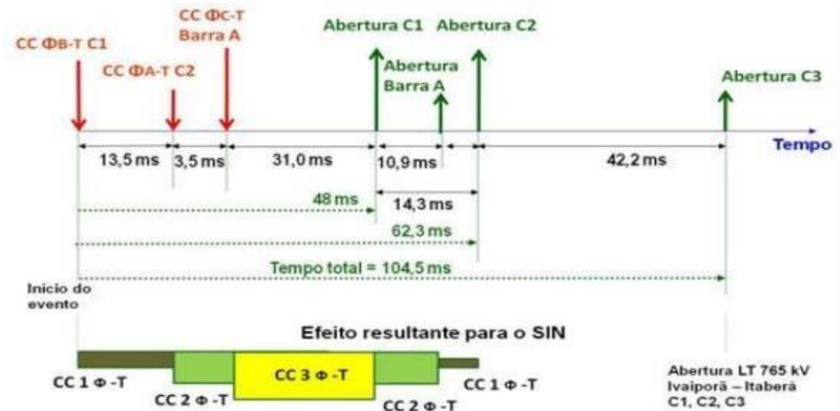
Figura 5. Tempo total do curto-circuito trifásico em SE Itaberá.
