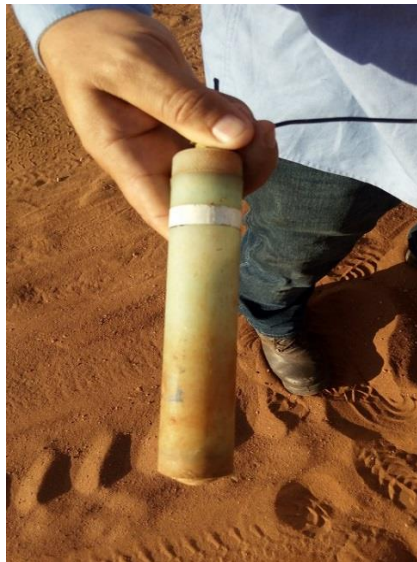
Figura 4. Semi-célula Cu/CuSO 4 de sulfato e cobre do tipo portátil, para medição do potencial.
