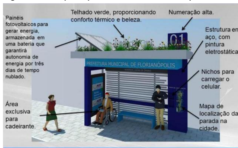
Figura 5. Protótipo de ponto de ônibus acessível para todos.
