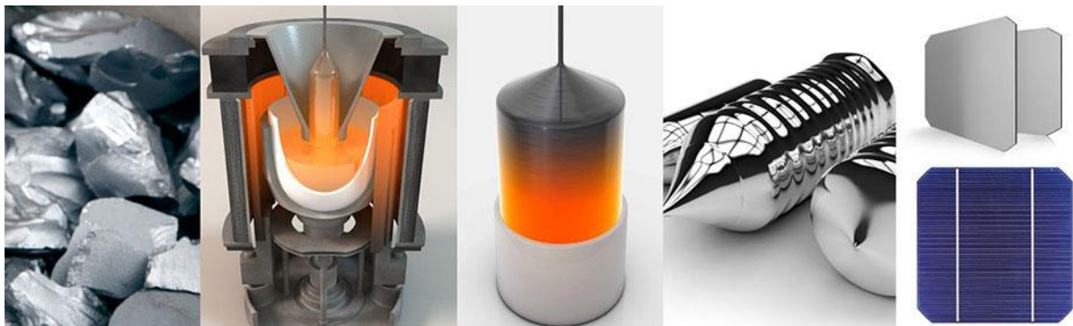
Figura 2. Processo de fabricação das células fotovoltaicas monocristalinas.
