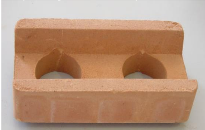
Figura 1. Tijolo de solo-cimento tipo caneleta para a execução de vergas e cintas de amarração.
