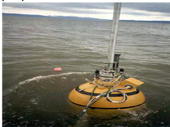
Figura 2. Corpo oscilante Norwegian buoy (1983).
