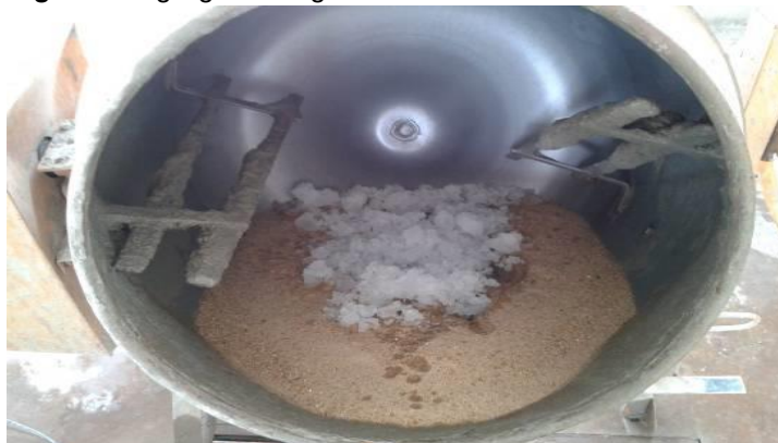
Figura 1. Agregados + gelo colocados na betoneira.
