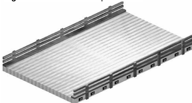
Figura 1. Ponte laminada protendida.
