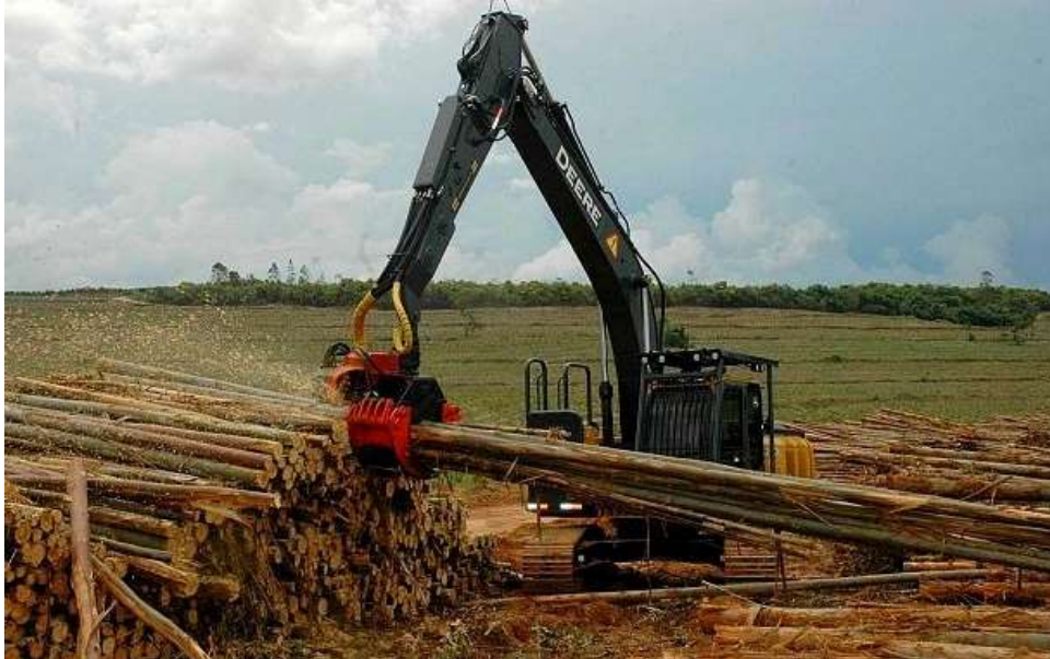
Figura 8: Escavadeira John Deere 200D LC – Garra Traçadora.
